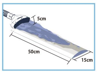
ABS から排出されるエアーバリアの大きさは長さ約 50cm、幅約15cm、高さ約 5cm です。ノズルはしっかりと固定でき、設置場所を変えることが可能です。
